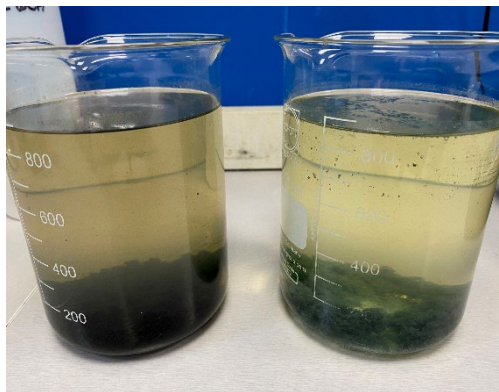
Visueel aspect na bezinking (links met ijzerchloride, rechts met AQUA NC 100)
